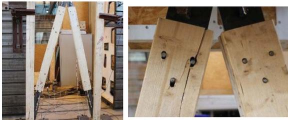
Figure 1 – Structure poteau-poutre contreventé, zoom sur un assemblage après un essai destructif
