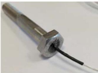
Figure 1 : Vis instrumentée TM-FAST-TH
