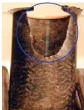
Figure 1 : Profil d'usure des douilles VSV
