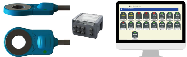
Figure 2: Capteur filaire transmission des données en 4G vers une application.
