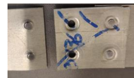
Figure 3 : Rupture par déboutonnage – Essais traction simple cisaillement - RAPP sur alu 2024
